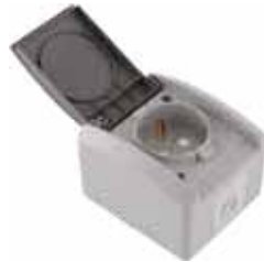
Dvopolna priključnica sa zaštitom "F" tip Two-pole socket-outlet with protection "F" type 16A/250V; IP 54
