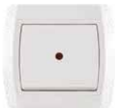
Jednopolna sklopka sa signalnom sijalicom Single-pole switch with pilot light 10AX/250V; IP 20
