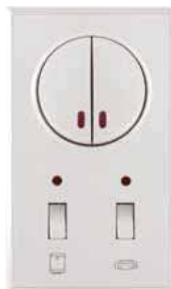
Vertikalna sklopka za kupatilo sa serijskom sklopkom i signalnim sijalicama Vertical bathroom switch with two-circuit switch and pilot lights 10AX/250V; 16AX/250V; IP 20
